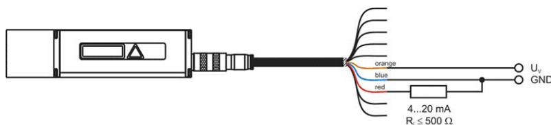
Bild 19 Beschaltung Analogausgang
